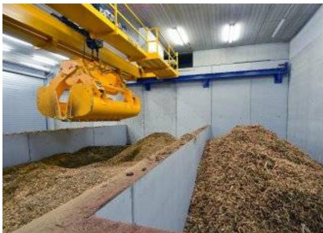
Les deux silos de la chaufferie du Wacken, à bois et à rafles, photo FD
