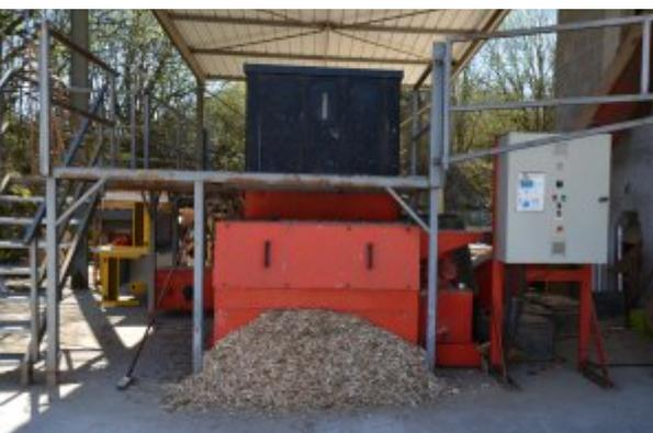
Broyeur lent UNTHA permettant la préparation du combustible chez Emmaüs 52, avec déversement direct dans le silo de la chaufferie, photo FD
