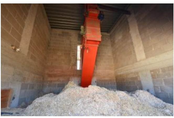
Le silo à combustible avec le convoyeur arrivant du broyeur UNTHA, photo FD
