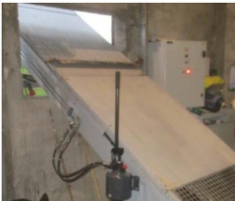
Soucieux d'apporter des aménagements pour répondre aux besoins d'exploitation, nous travaillons constamment sur les améliorations à apporter à nos matériels. Dans ce cadre nous vous proposons la mise en place d'un système de tension hydraulique sur le transporteur à cendres. L'avantage de ce dispositif est de tendre et détendre la chaîne du transporteur à cendres avec une pompe manuelle depuis le sol.
